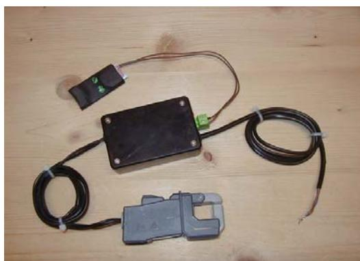
*Figure 1 : Wattmètre pince, avec son pulse mètre et sa pince ampèremétrique*
