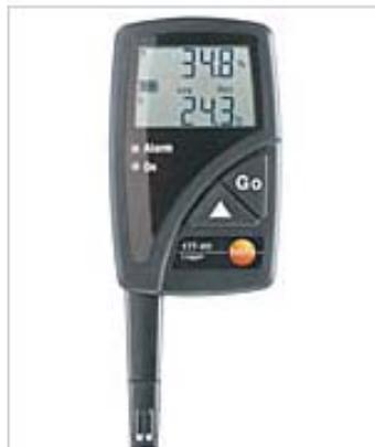
*Figure 6 : Thermo hygromètre*
