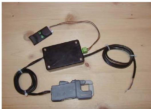
*Figure 1 : Wattmètre pince, avec son pulse mètre et sa pince ampèremétrique*
