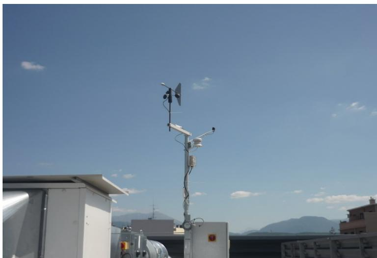
**Figure 4.3.6 : Station météo mise en place sur le toit du bâtiment**
