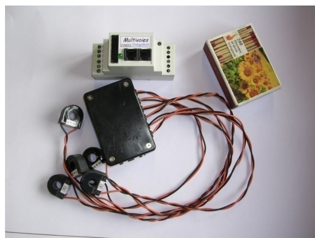
Figure A1.1: Description schématique du système multivoies pour le suivi des départs en tableau électrique – Echelle donnée par une grosse boîte d'allumettes
