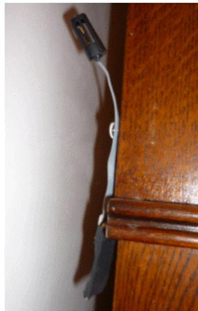
*Figure A2.4 : Thermohygromètre installé derrière une armoire*
