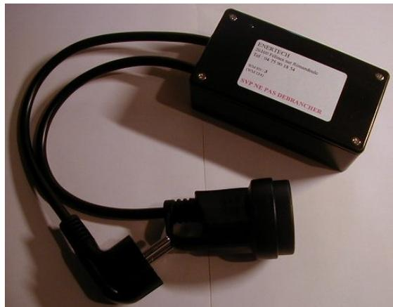
*Figure 2.2 : Photographie d'un wattmètre série*
