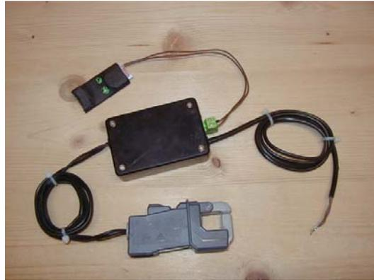
*Figure 2.1 : Photographie d'un wattmètre pince*
