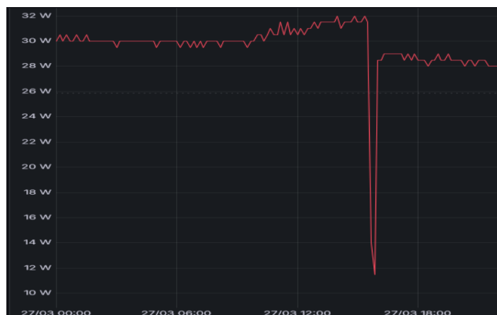
Figure 47 : Passage immédiat de la puissance appelée de 32 à 28,5 W après nettoyage des filtres
