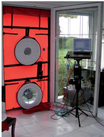
Fig. 3 : Porte soufflante et ordinateur de pilotage
