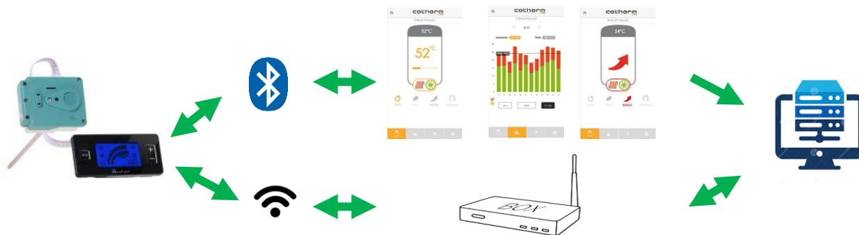
Figure 30 : chaînes et protocoles de communication du thermostat COTHERM.
