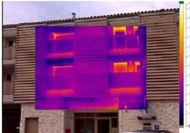
**Figure 2.2.5 : Exfiltrations chaudes par les tabliers des volets roulants (en façade)**
