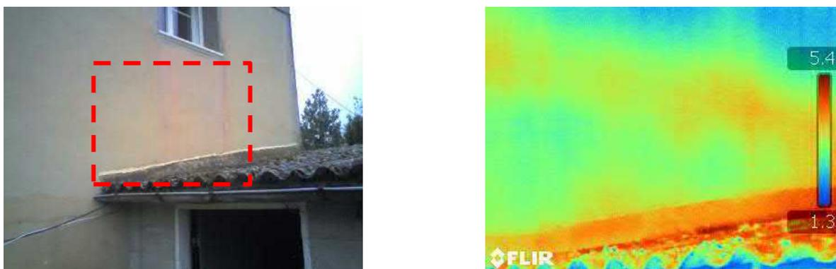
Figure 78 : Thermogramme de mur isolé par l'intérieur, au niveau du plancher intermédiaire béton.
