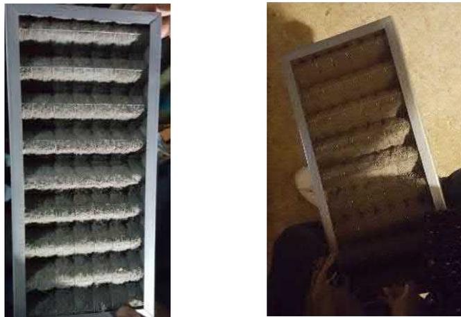
Figure 177 : Filtres à la pose (gauche) et à la dépose (droite).
