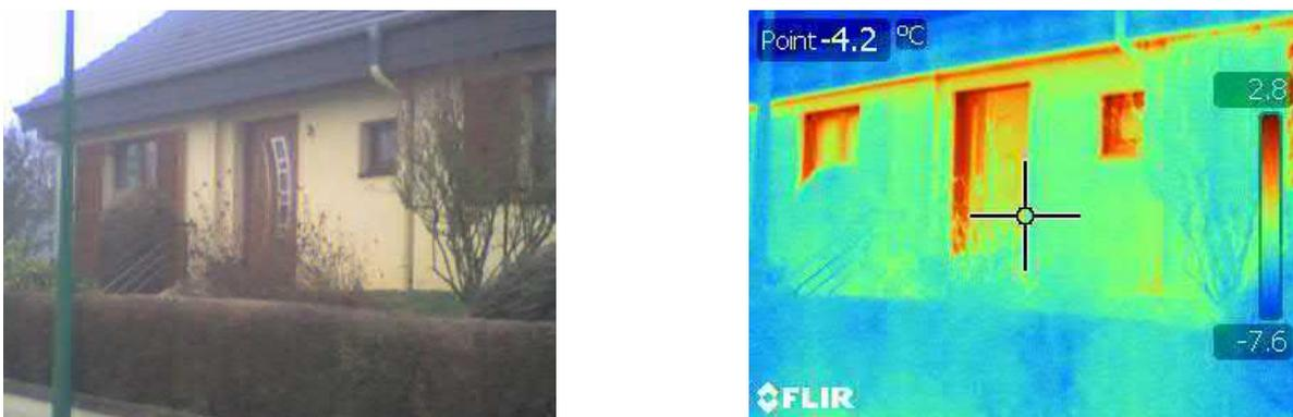
Figure 84 : Thermogramme de la liaison du mur avec les menuiseries en l'absence de retour d'ITE (rénovation par gestes).
