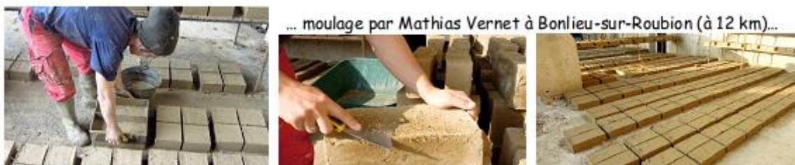
Fig. 1.3 : Fabrication des briques de terre crue
