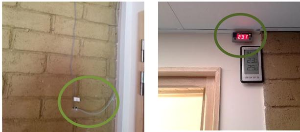
Figure 4 : Dispositif de mesure et affichage de la température de masse du bâtiment.
