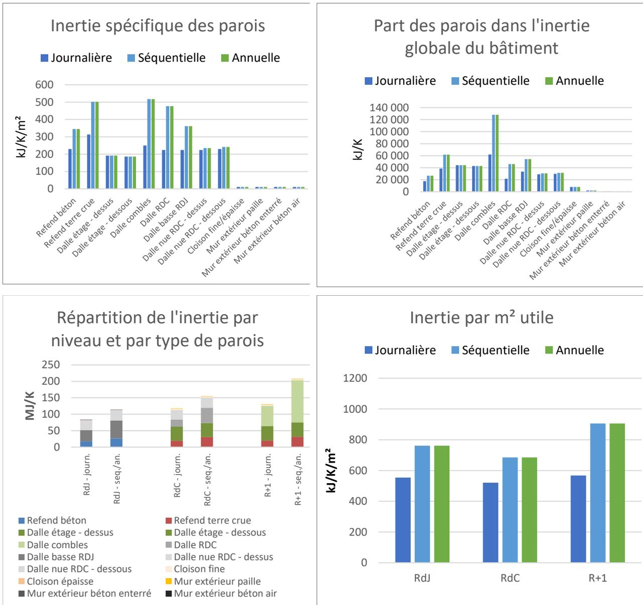
Figure 2.2.1.d – Répartition de l’inertie mobilisable par type de parois et par niveau du bâtiment.
