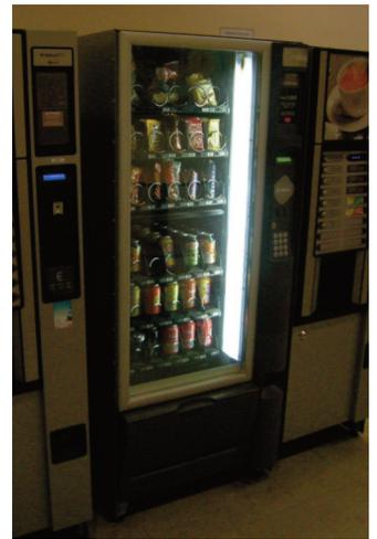
Aucun distributeur de boissons froides n'a été installé compte tenu de leur consommation. Ces appareils sont en permanence éclairés et maintenus à 10°C malgré une isolation inexistante sur la face avant.
