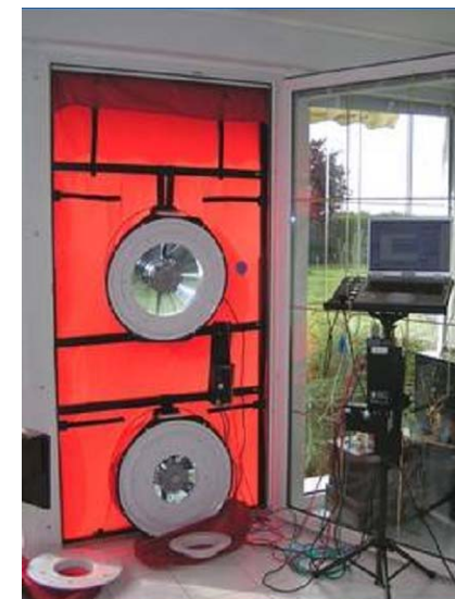
Photo 2 : porte soufflante ou blower door (Source : Alsatech)
