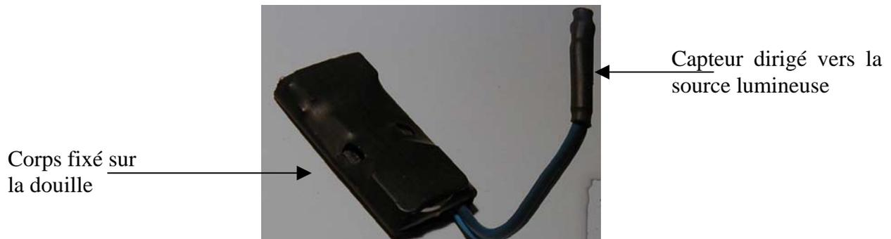
**Figure 1.11 : Photographie d'un lampemètre**
