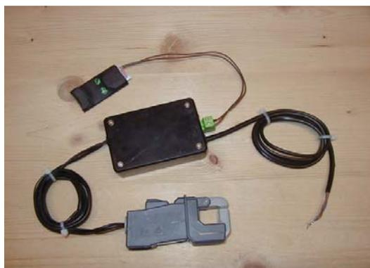
*Figure 2.9 : Wattmètre pince, avec son pulse mètre et sa pince ampèremétrique*
