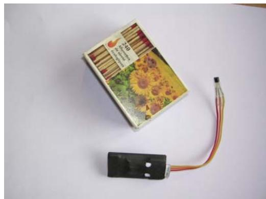
*Figure 2.13 : Thermomètre avec sa sonde et son microprocesseur – Echelle donnée par grosse boîte d'allumettes*
