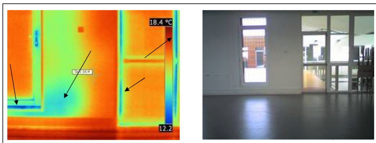
Figure 2.3 : Illustration des infiltrations entre les liaisons ouvrants/dormants
