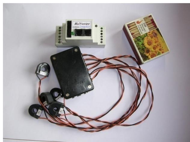
**Figure A2.1: Description schématique du système multivoies pour le suivi des départs en tableau électrique – Echelle donnée par une grosse boîte d'allumettes**
