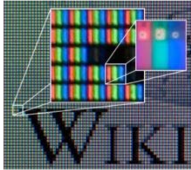
Figure 2.1 : Détail d'un écran à cristaux liquides couleur
