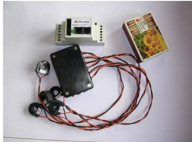
Figure 2 : Description schématique du système multivoies pour le suivi des départs en tableau électriques – Echelle donnée par une grosse boîte d'allumettes
