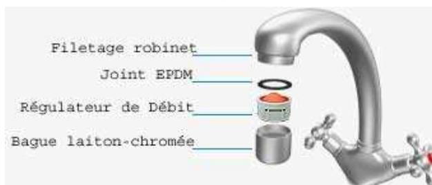
Mise en place d'un aérateur sur un robinet. Source: Ecoperl
