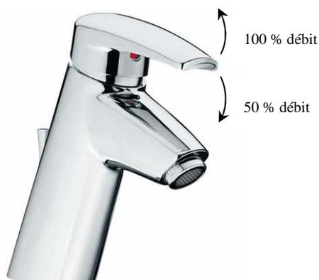
**A noter** : il existe des robinets avec butée à mi-chemin limitant le débit à 6 /min pour les utilisations fréquentes (lave mains...) et le débrayage pour le remplissage des récipients. Ils sont recommandés pour les éviers, dans les logements neufs ou rénovés.
