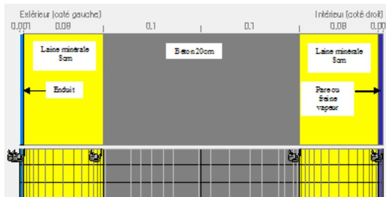
FIGURE 8 – Paroi simulée sous WUFI pour l’isolation mixte.
